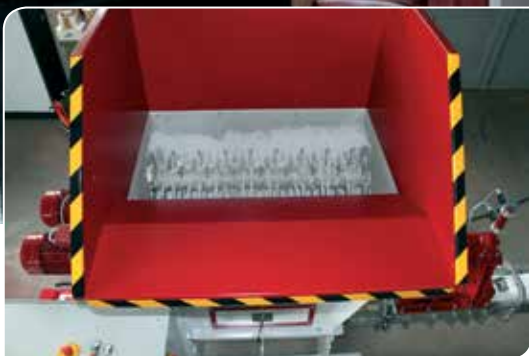
En effektiv grovkvärn med tvåtandade roterande axlar
