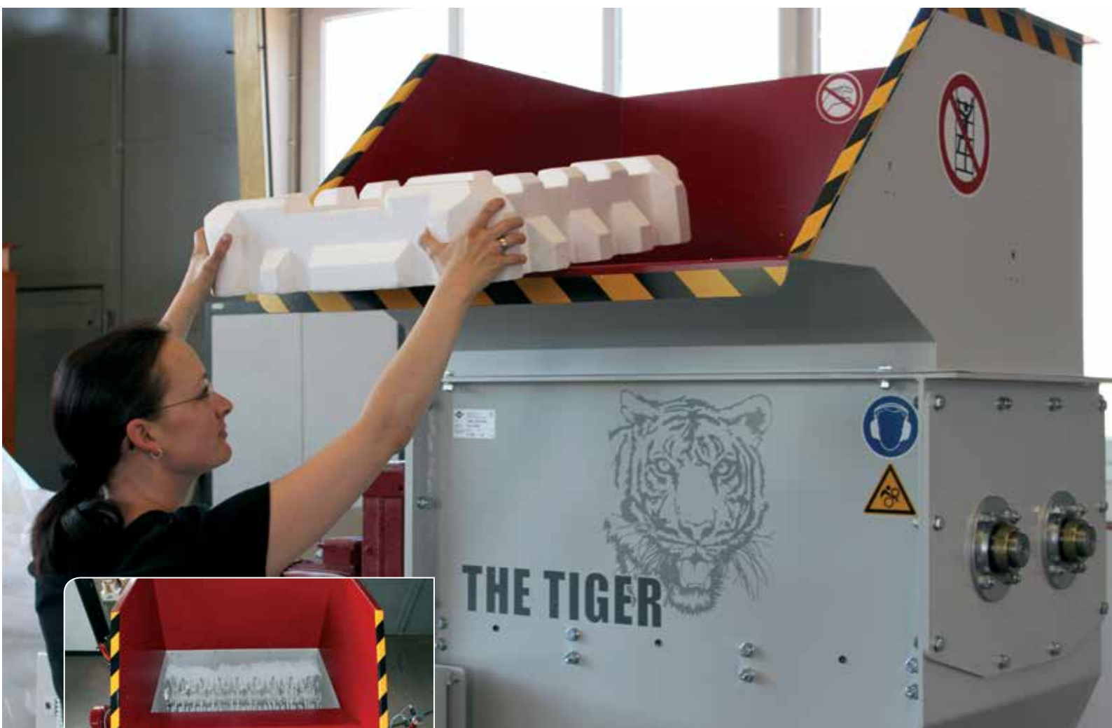
En effektiv grovkvarn med tvåtandade roterande axlar
