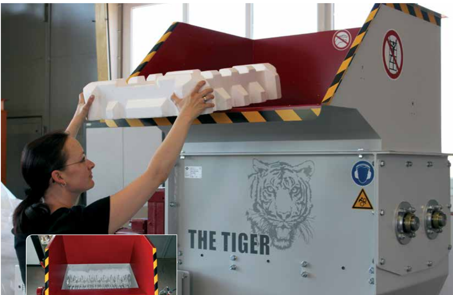
En effektiv grovkvarn med tvåtandade roterande axlar
