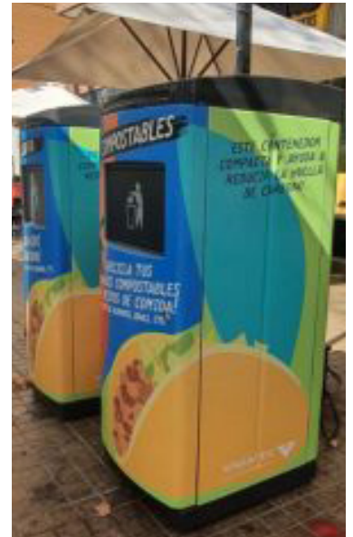
Compactación de 8 a 1
