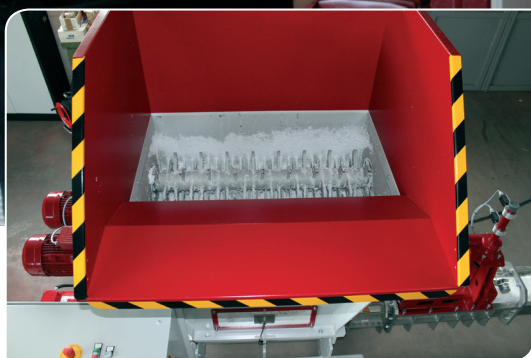
En effektiv grovkvärn med tvåtandade roterande axlar
