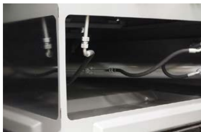
Självrensande tråg i pressdelen
